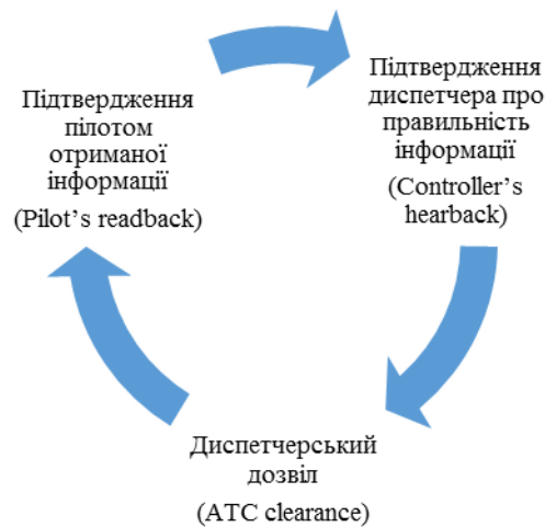
Рис. 1. Схема ведення стандартного радіозв'язку між пілотом і диспетчером у повітрі та на землі
