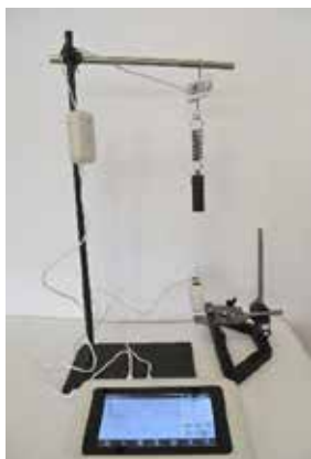
Рис. 1. Установка для визначення жорсткості пружини
