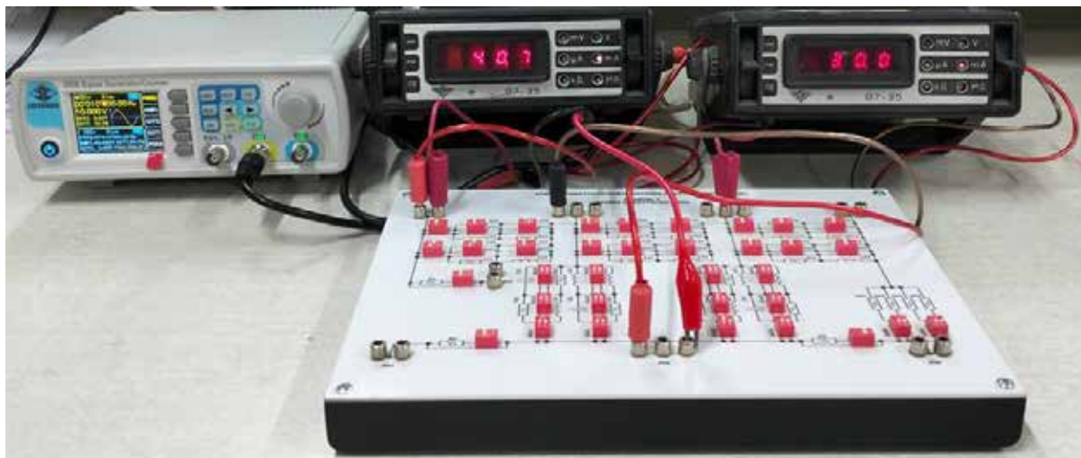
Рис. 9. Зовнішній вигляд установки для дослідження резонансу струмів.
