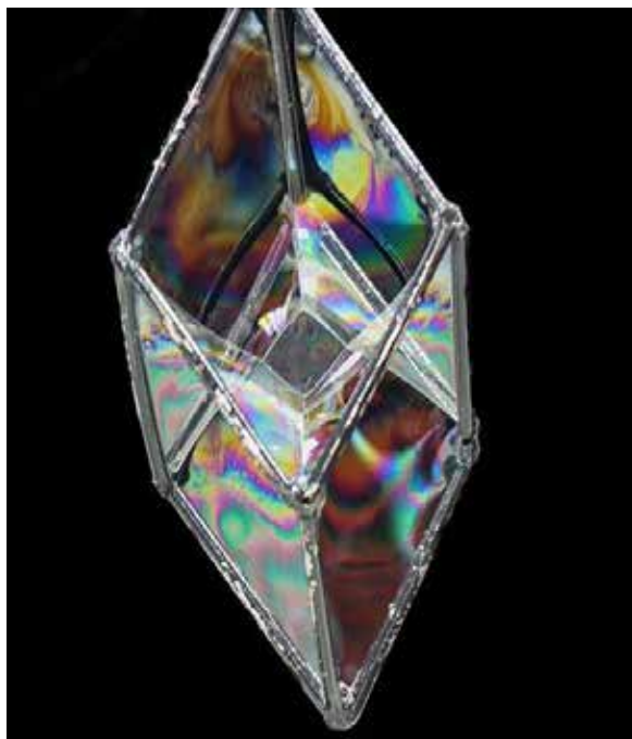
Рис. 10. Каркас ромбоєдра, занурений у мильний розчин. В центрі перетинка у вигляді ромба
