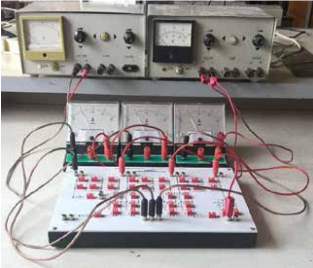
Рис. 5. Схема експериментальної перевірки принципу накладання струмів
